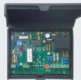
Decoder-Gehäuse für Codetaster CTR 1b-1, CTR 3b-1, CTV 3-1, CTP 3
